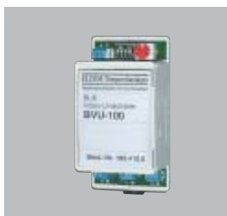
BVU-100 i2-BUS Video-Umschalter Video-Umschaltgerät für Mehrtüranlagen zur Umschaltung der Videokamera. Kaskadierbar für mehrere Türen. Versorgung und Steuerung über den i2-BUS. Adresseinstellung durch Drehschalter. Funktionsanzeige bei aktiver Umschaltung.
