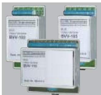
BVV-103 BVV-105 BVV-110 i2-BUS Videoverteiler zur sternförmigen Verteilung des Videosignals mit 3, 5 oder 10 Ausgängen. Kaskadierung zum Anschluss weiterer Verteiler.
